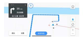
4.1.2 在导航状态下, 手机锁屏, 仪表仍然会显示导航地图, 界面如图:
